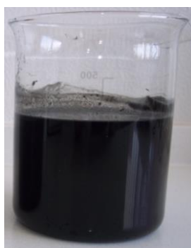
Figura 4: Lodo anaerobio empleado para la inoculación de los reactores UASB
