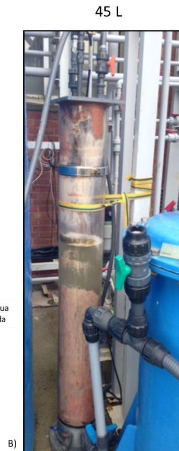
Figura 5: A) Esquema de diseño del sistema de recuperación de metano disuelto. B) Fotografías de los dos prototipos empleados (p45 y p166).
