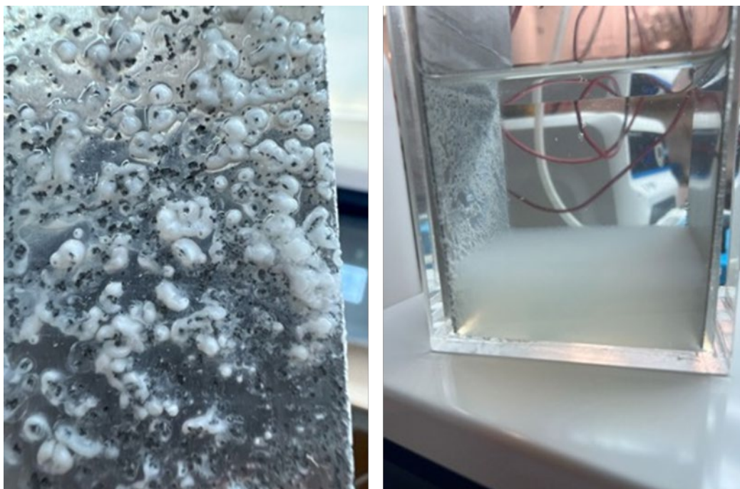
Figura 6.6. Detalle de la precipitación de fosfato de aluminio sobre el electrodo y depositado en el fondo de la celda electroquímica al final del experimento.
