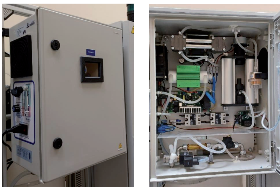
Figura 3-8. Planta piloto Photobench LED275-0.8/LED365-16/450-16a (APRIA Systems): Sistema de ozonización.
