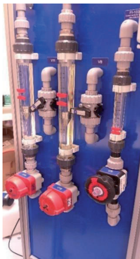
Figura 3-9. Planta piloto Photobench LED275-0.8/LED365-16/450-16a (APRIA Systems): Caudalímetros F101, F102 y F103.
