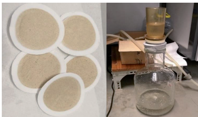
Figura 3-1. Filtros y bomba de vacío empleados para la filtración de agua residual real.
