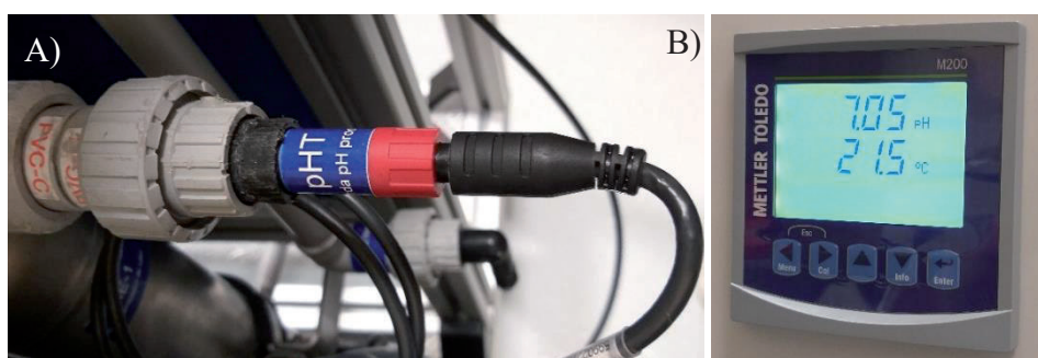
Figura 3-10. Planta piloto Photobench LED275-0.8/LED365-16/450-16a (APRIA Systems): A) sensor de pH y temperatura y B) transmisor analítico.
