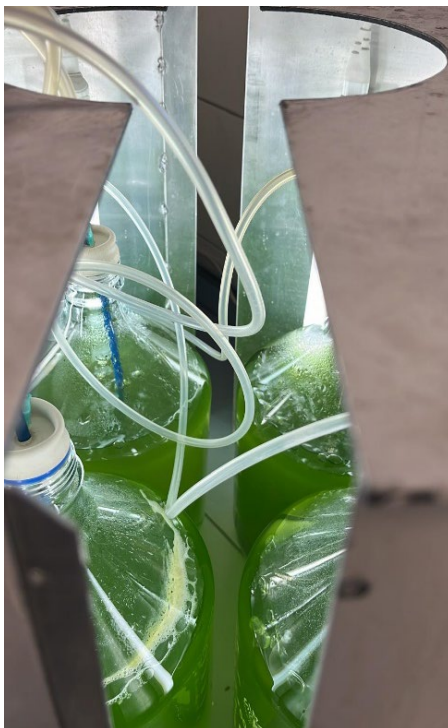
Figura 3 - 12. Fotobiorreactores empleados en el cultivo de Scenedesmus sp. y C. vulgaris .
