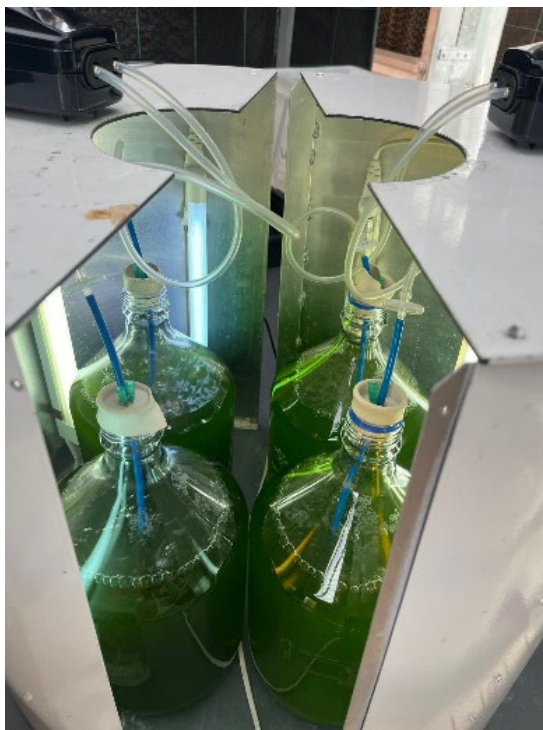
Figura 3 - 16. Sistema de cultivo de los experimentos LOM de 5 L.
