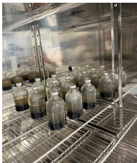
Figura 3 - 14. Instalación experimental para la producción de biogás.
