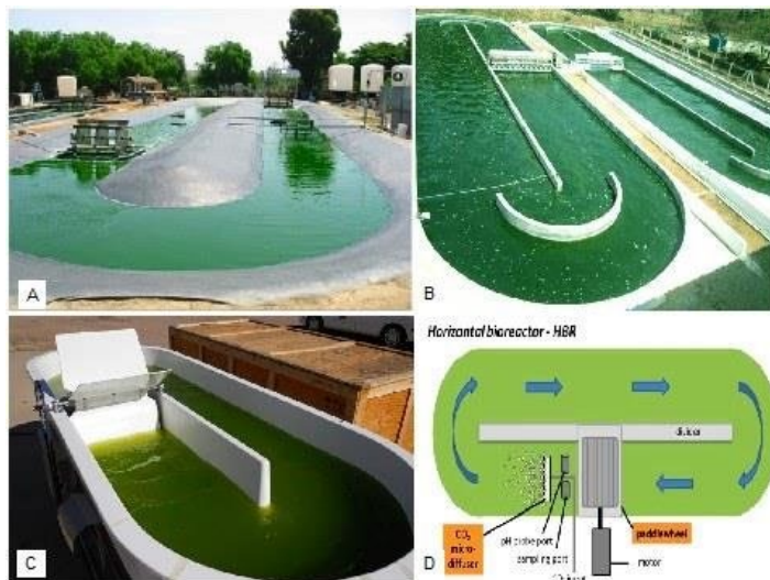
Figura 1 - 24. Estanques abiertos para el cultivo de microalgas. Fuente: Pal et al. (2018) [242]
