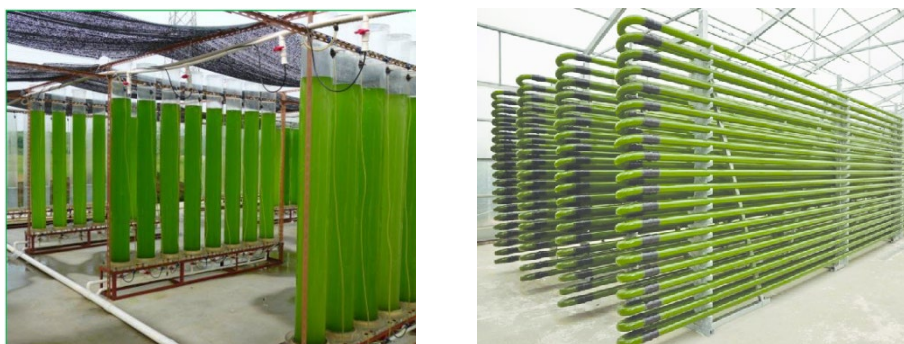
Figura 1 - 27. Izquierda: fotobiorreactor tubular vertical. Fuente: Huo et al. (2018) [246]. Derecha: fotobiorreactor tubular horizontal. Fuente: Alaswad et al. (2015) [247].
