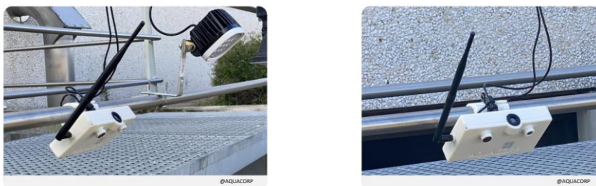
Figura 1. Cámara multiespectral inteligente. (Imagen cedida por AQUACORP)
