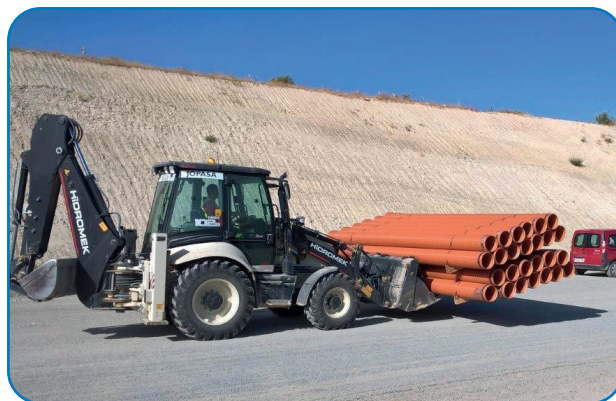
Foto 1 y 2. Descarga de paquetes con pinzas.
