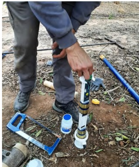
Figura 3.- Instalación de sondas de humedad para el monitoreo continuo de la humedad del suelo
